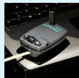
L'émetteur-récepteur RFS pour le dialogue entre l'ordinateur et les générateurs ou flashes compacts
